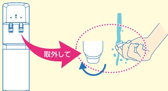
蛇口先端の透明なキャップは外して洗うことができます。
